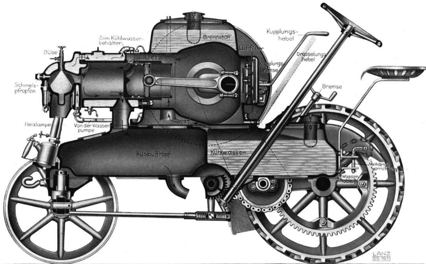
Längsschnitt durch den Schwerölmotor »Bulldog«
